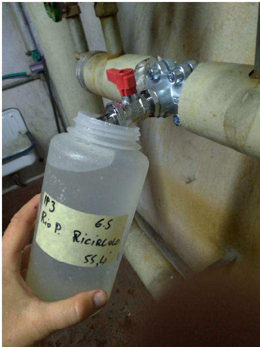
Fig. 3 – prelievo del campione da presa su condotto ricircolo acqua calda sanitaria
